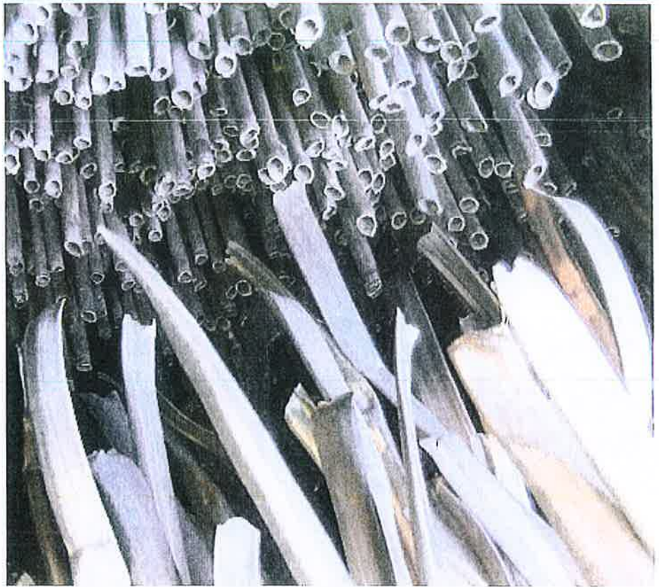
Bilde 6: Nærbilde av titanrørene. Diameter på ca. 3 cm.
